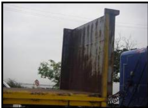
CORRECTO: SOPORTE ADECUADO EN LA TRASPORTACIÓN DE CARGA
