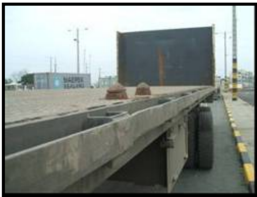
FORMA CORRECTA: VEHÍCULO EN BUENAS CONDICIONES ( PLATAFORMA Y TWIST LOCK TANTO PARA CONTENEDORES DE 20' Y 40'.
